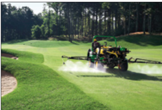
Zdjęcie 21. Opryskiwacz służy do oprysków środkami ochrony roślin i nawożenia płynnym nawozem.
