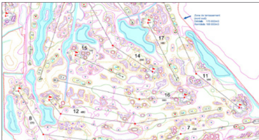
Rysunek 17. Część projektu przesunięć mas ziemnych dla pola Koksijde w Belgii.
